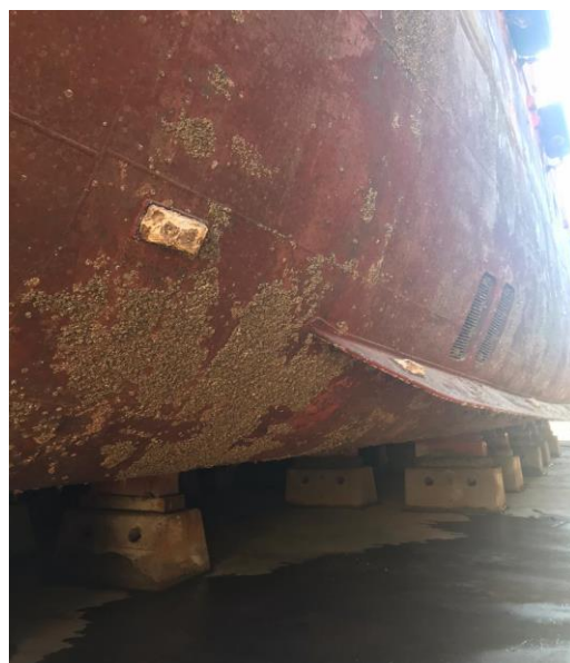
Foto do casco da popa de boreste. Evidência de ausência do coral sol ( Tubastraea spp. ).
