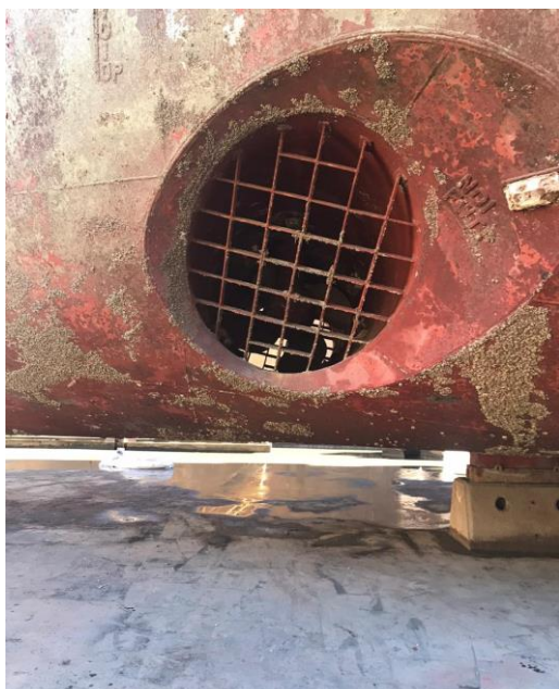
Foto do thruster da proa de boreste. Evidência de ausência do coral sol ( Tubastraea spp. )..
