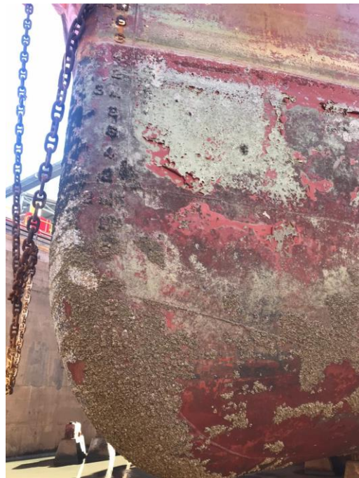
Foto do casco da proa de boreste. Evidência de ausência do coral sol ( Tubastraea spp. ).
