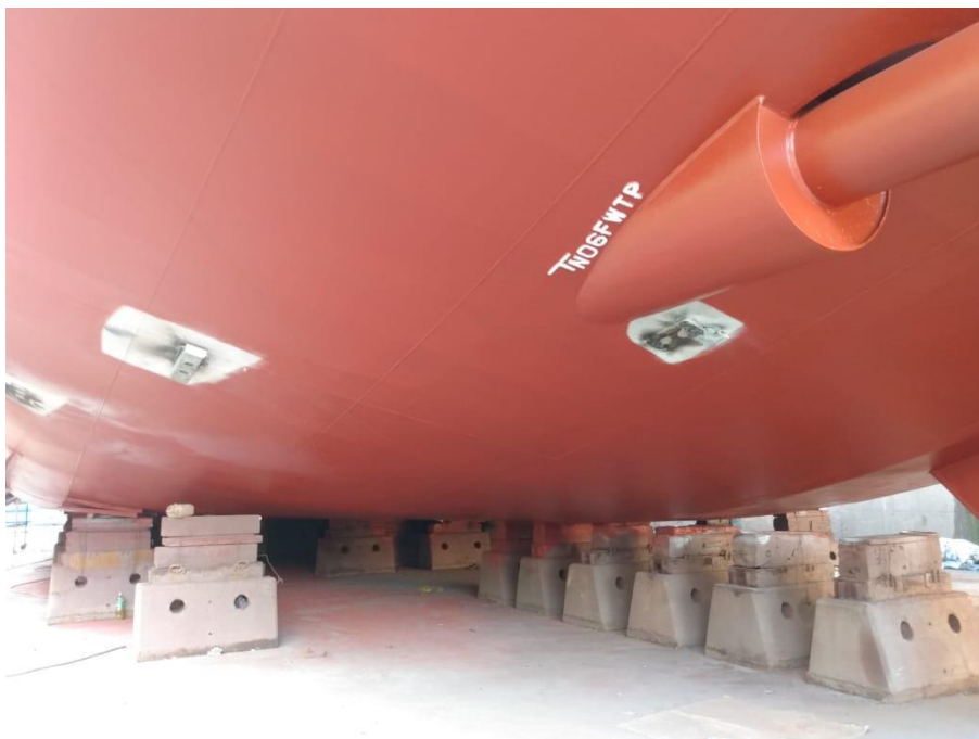
Foto da parte inferior do casco de bombordo. Evidência após limpeza e reforma.
