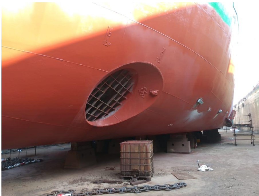
Foto do casco da proa de bombordo. Evidência após limpeza e reforma.
