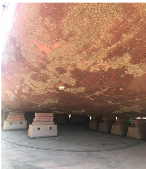
Foto do casco da popa de bombordo. Evidência de ausência do coral sol ( Tubastraea spp. ).
