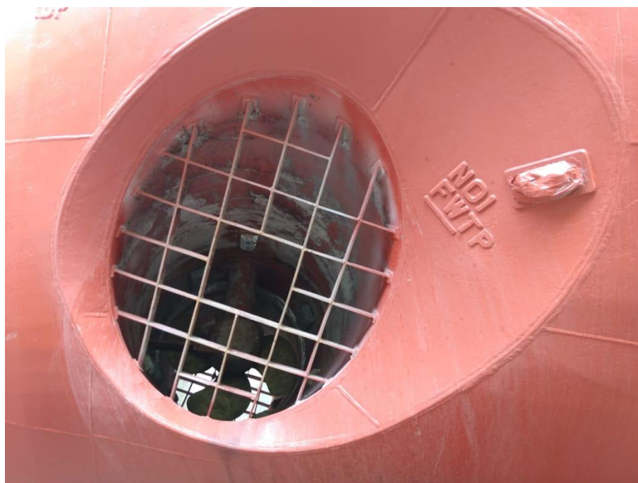
Foto do thruster da proa de bombordo. Evidência após limpeza e reforma.
