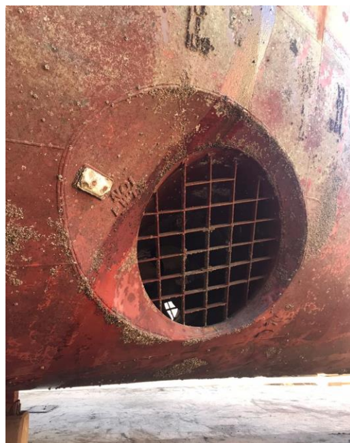
Foto do thruster da proa de bombordo. Evidência de ausência do coral sol ( Tubastraea spp. ).
