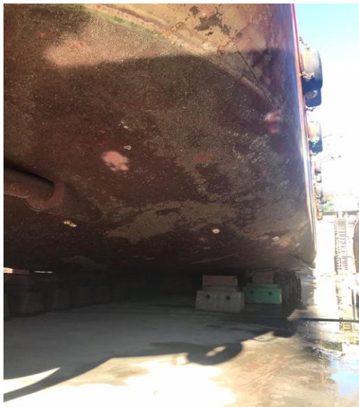
Foto do casco da proa de bombordo. Evidência de ausência do coral sol ( Tubastraea spp. ).
